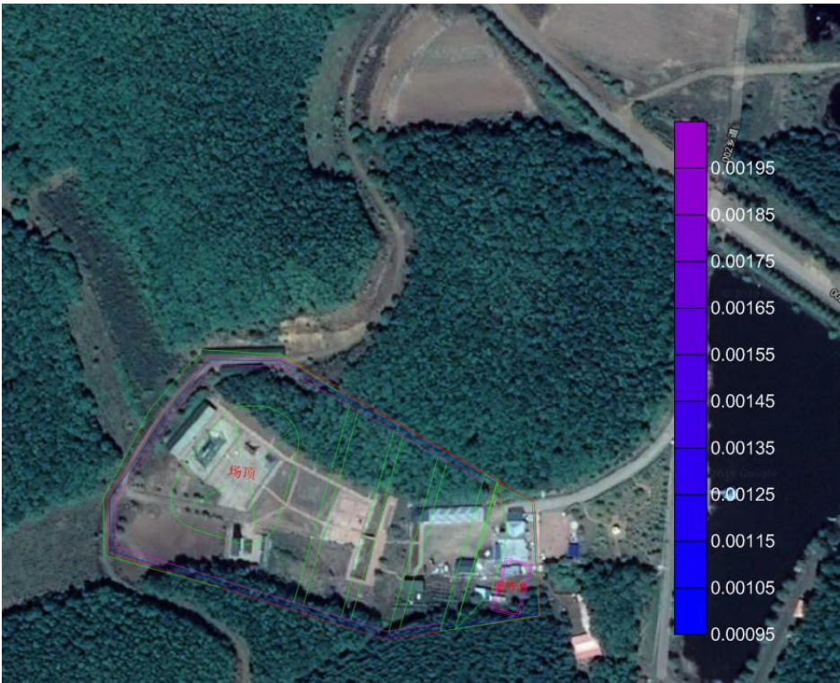
图 6-2-10 非正常情况下飞灰填埋场泄漏 1000d 铅污染物浓度等值线图
