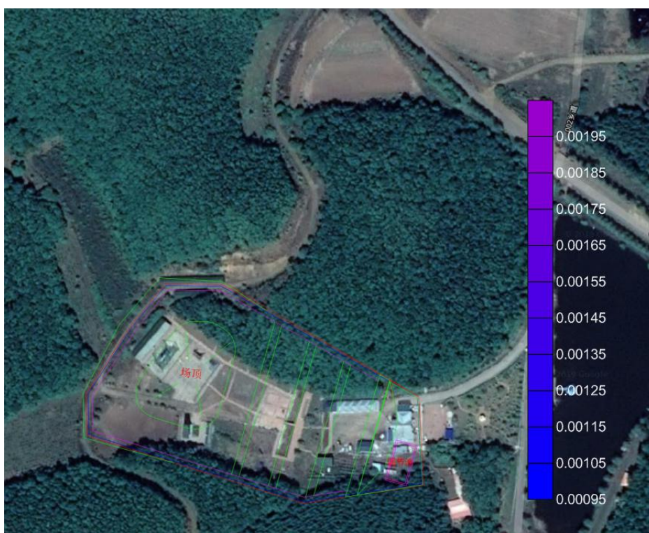
图 6-2-9 非正常情况下飞灰填埋场泄漏 100d 铅污染物浓度等值线图
