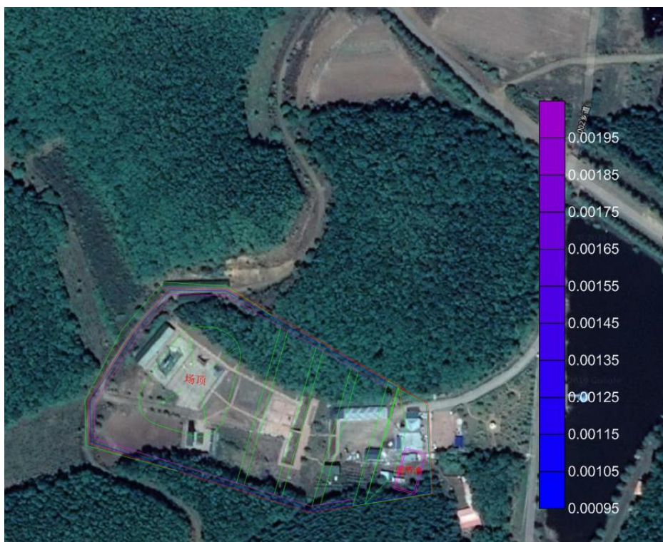
图 6-2-8 非正常情况下飞灰填埋场泄漏 30d 铅污染物浓度等值线图
