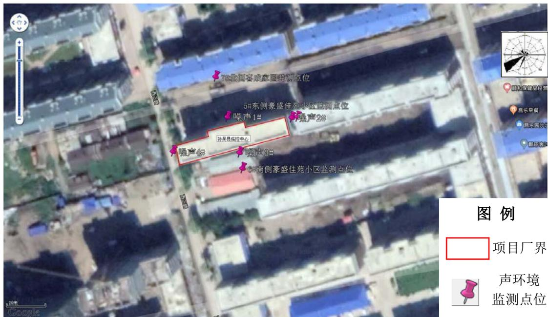
图 4-4-1 新建厂址声环境监测点位布设图
