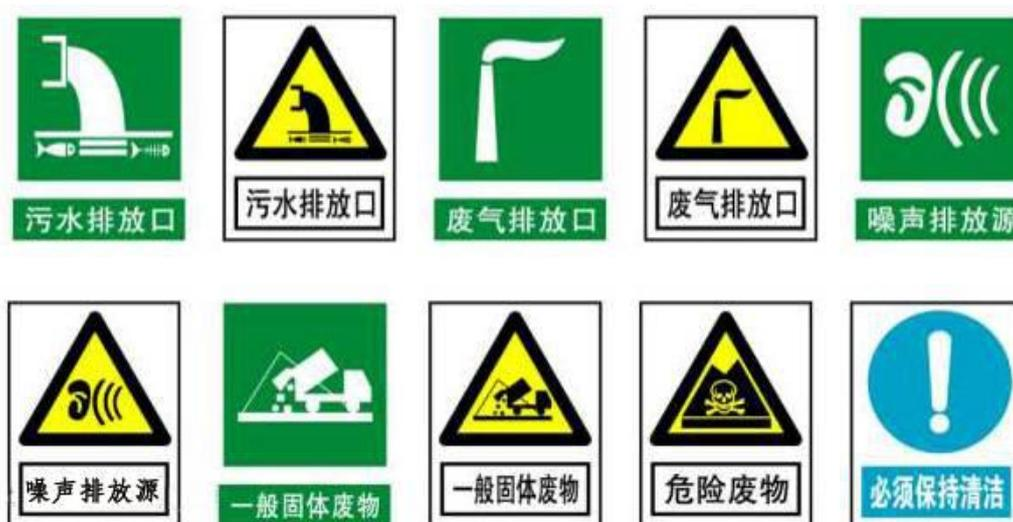
图 8-4-1 排污口图形标志示例
