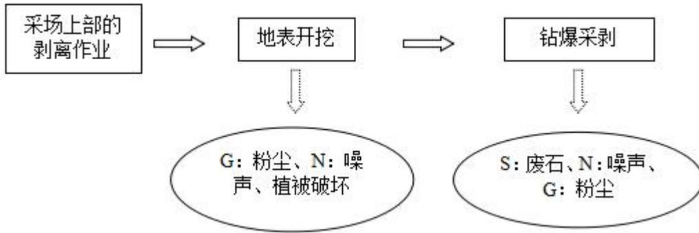
图3.2-2 施工期工艺流程
