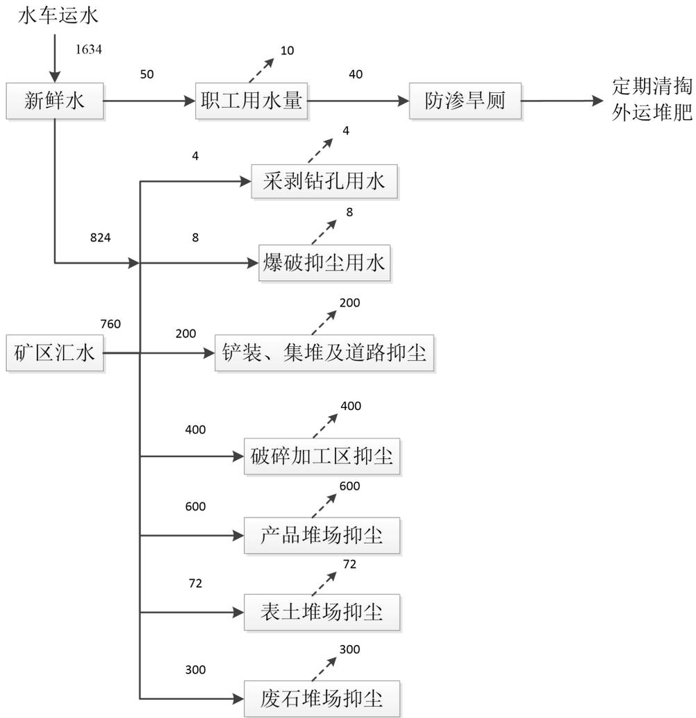
图3.2-1 项目水平衡图 单位m<sup>3</sup>/d
