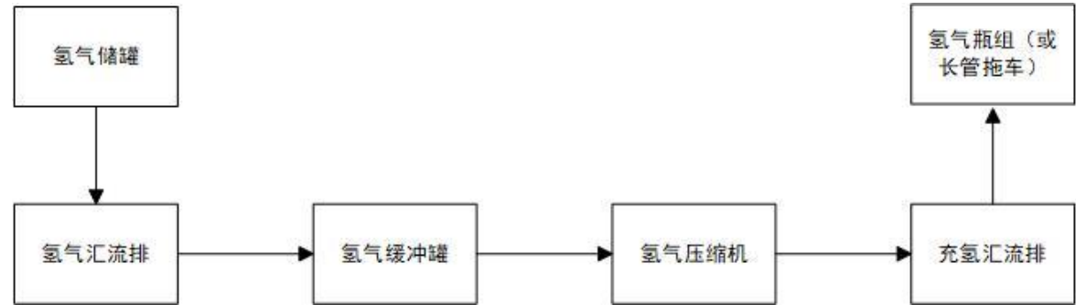
图3.6-2 供氢系统工艺流程
