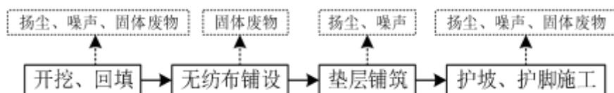
图4-1 护坡施工工序流程及产污节点图
