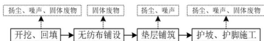
图4-1 护岸施工工序流程及产污节点图
